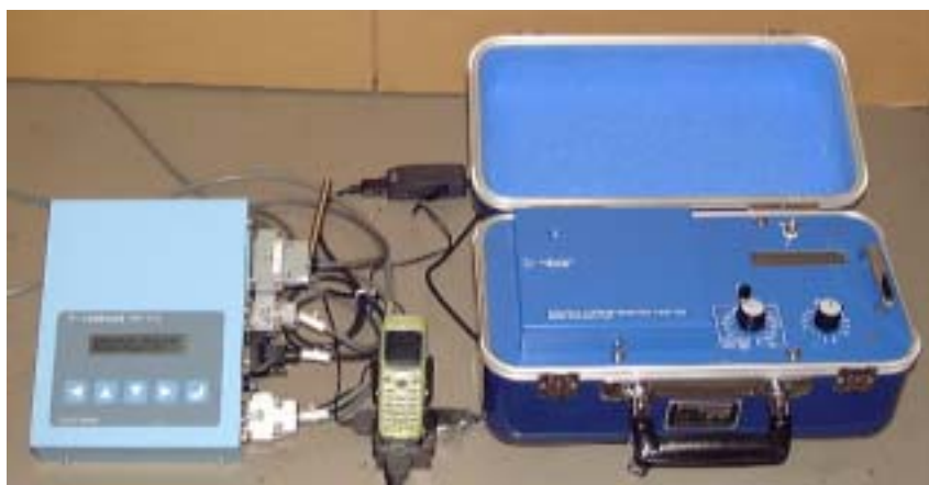
データ収録転送装置（プロトン磁力計と組合わせた簡易接続の一例です。）
